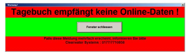
Bei wiederholtem Auftreten dieser Meldung beenden Sie den CLEARGET-Datenserver und überprüfen Sie nach ein paar Minuten, ob diese Datei dort vorhanden ist.
